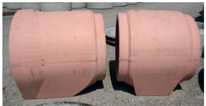
Трубы стандартной монтажной длины 3 м и шарнирно-фитинговые детали изготавливаются по технологии твердения в опалубке
