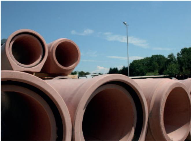
Теперь трубы группы номинального диаметра 2 и 3 выпускаются с плоской подошвой - на фото изображена железобетонная труба диаметром DN800
