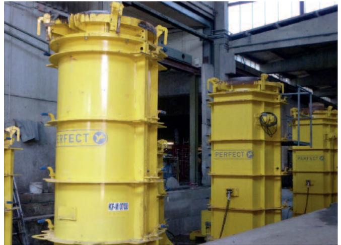
Для производства труб номинального диаметра от DN700 до DN1200 компания Beton Muller использует литьевые формы, установленные в заглубленном участке цеха
